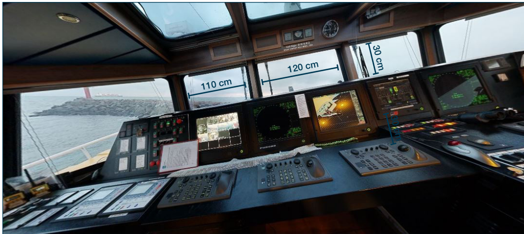
Figur 20: Vinduers størrelse og udsyn på broen. Kilde: DMAIB
