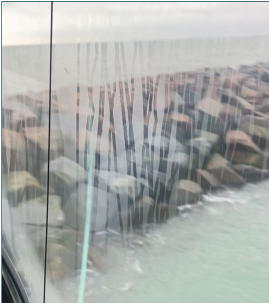
Figur 21: Vindue i styrbord side af styrehuset med kondens. Kilde: DMAIB
