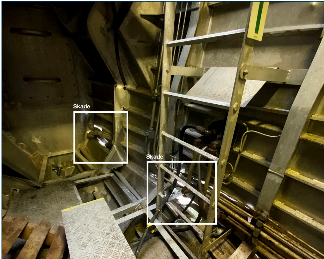
Figur 7: Skrogskade i voidspace. Kilde: DMAIB
